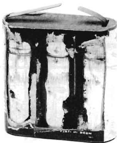
Fig. 2 - Tutte le pile con valore superiore a 1,5 V sono composte da più elementi da 1,5 V ciascuno. Per esempio, le pile da 4,5 V, di cui la foto mostra la parte interna, costituiscono un collegamento in serie di tre elementi da 1,5 V.
